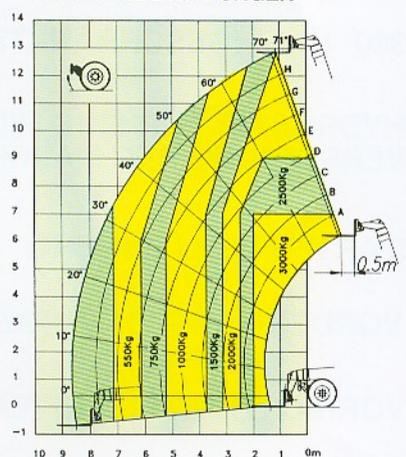
Tragkräfte: bei 500 mm Lastschwerpunktstand (FEM 4001r)
